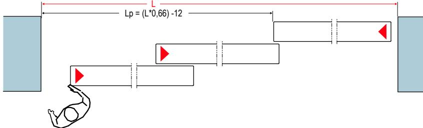
L: larghezza muro (misura d'ordine) x H: Altezza muro (misura d'ordine) Lp: Luce passaggio
