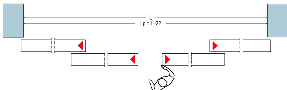
L: larghezza muro (misura d'ordine) x H: Altezza muro (misura d'ordine) Lp: Luce passaggio
