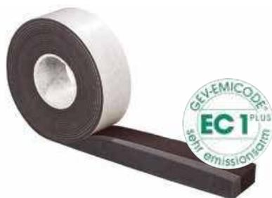
Nastro autoespandente multifunzionale con una pellicola di tenuta aria e vapore interna. Unisce i vantaggi dei nastri auto espandenti e delle pellicole di tenuta aria e vapore in un unico prodotto. Specificatamente studiato per la sigillatura della parte interna e mediana del giunto di collegamento della finestra al controltaio. Realizza giunti ad alta impermeabilità all'aria, al vapore e al rumore.
