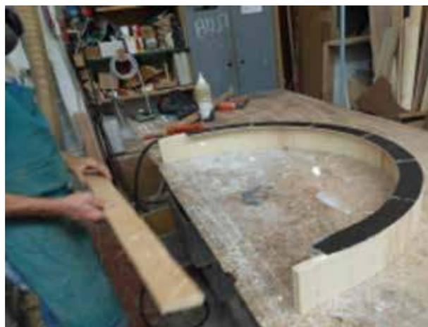
Esempio di costruzione controtelaio con curvatura superiore (profilo T Flex + battuta Profile)
