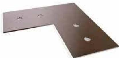
Piastra di allineamento 80x80 mm, spessore 1 mm esterna per il controtelaio Klima Pro realizzata in acciaio zincato. Con questo accessorio si garantisce il perfetto allineamento della battuta nell'angolo, evitando possibili disassamenti. È dotata di prefori per essere avvitata direttamente all'esterno della battuta del controtelaio, con viti 3,5x16mm
