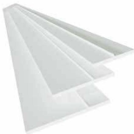
Battuta in PVC riciclato per la formazione della battuta sul controtelaio dello spessore di 3,5 mm e provvista di un dentino di allineamento per il posizionamento lungo la spalla. Costituisce la migliore soluzione per creare la battuta di appoggio per la posa dei serramenti. Rappresenta dal punto di vista termico la soluzione migliore per sostituire la battuta in alluminio e risolve quindi qualsiasi problema di condensa all'interno del nodo.
