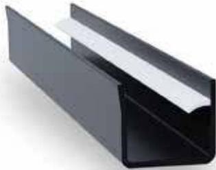
Profili rigidi in PVC con aletta morbida di tenuta appositamente sagomati per accogliere il pannello Flexoterm. Queste barre vengono applicate sul muro e sul fondo del cassonetto per contenere i pannelli isolanti. Disponibili in 2 versioni: una più larga per i pannelli della linea Flexoterm da 20 mm ed una più stretta per i pannelli della linea Flexoterm da 10 mm.
