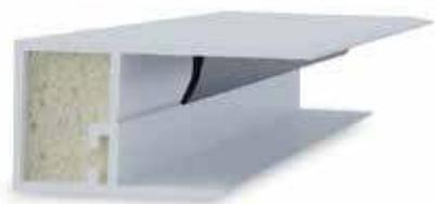
Profilo rigido in PVC isolato con schiuma poliuretanicca e provvisto di aletta morbida di tenuta. Profilo utilizzabile per la riqualificazione dei ciellini inferiori a sfilare.
