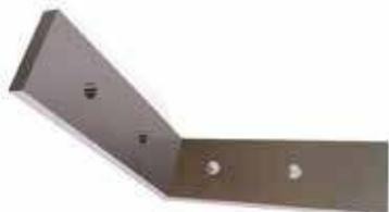
Squadretta in alluminio estruso 80x80 mm spessore 5 mm per realizzare la giunzione angolare del controteilaio Klima Pro. Grazie alla sua particolare geometria può essere inserita direttamente nelle nervature esterne del controteilaio Klima Pro. È dotata di prefori per fissarla direttamente al supporto.
