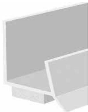
Profilo porta intonaco per raccordare il serramento alla lastra interna in cartongesso. Costruito con l'accoppiamento di un profilo in PVC speciale ed un materassino autoadesivo in polietilene impermeabile all'aria e al vapore: l'elasticità della spugna riesce a resistere a piccoli movimenti del muro evitando al formazione di crepe. Idoneo per lastre di cartongesso da 12,5 mm
