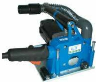
Speciale elettroutensile realizzato dal team di ricerca Posaclima, specificatamente studiato per il taglio del davanzale passante nella sostituzione dei serramenti. Dotato di doppio disco diamantato, realizza un taglio di 24 mm in meno di 3 minuti. Rispetto ai comuni scanalatori presenti sul mercato, lo scanalatore Renova presenta i seguenti vantaggi:
