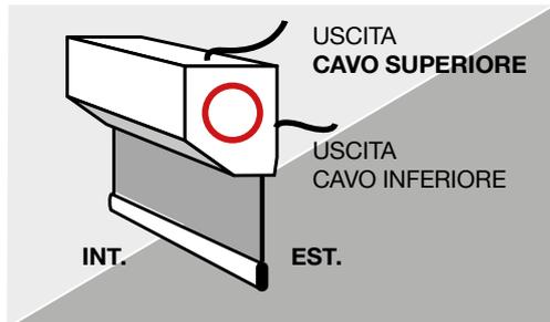
USCITA CAVO SUPERIORE O INFERIORE LATO DX O SX VISTA INTERNA
