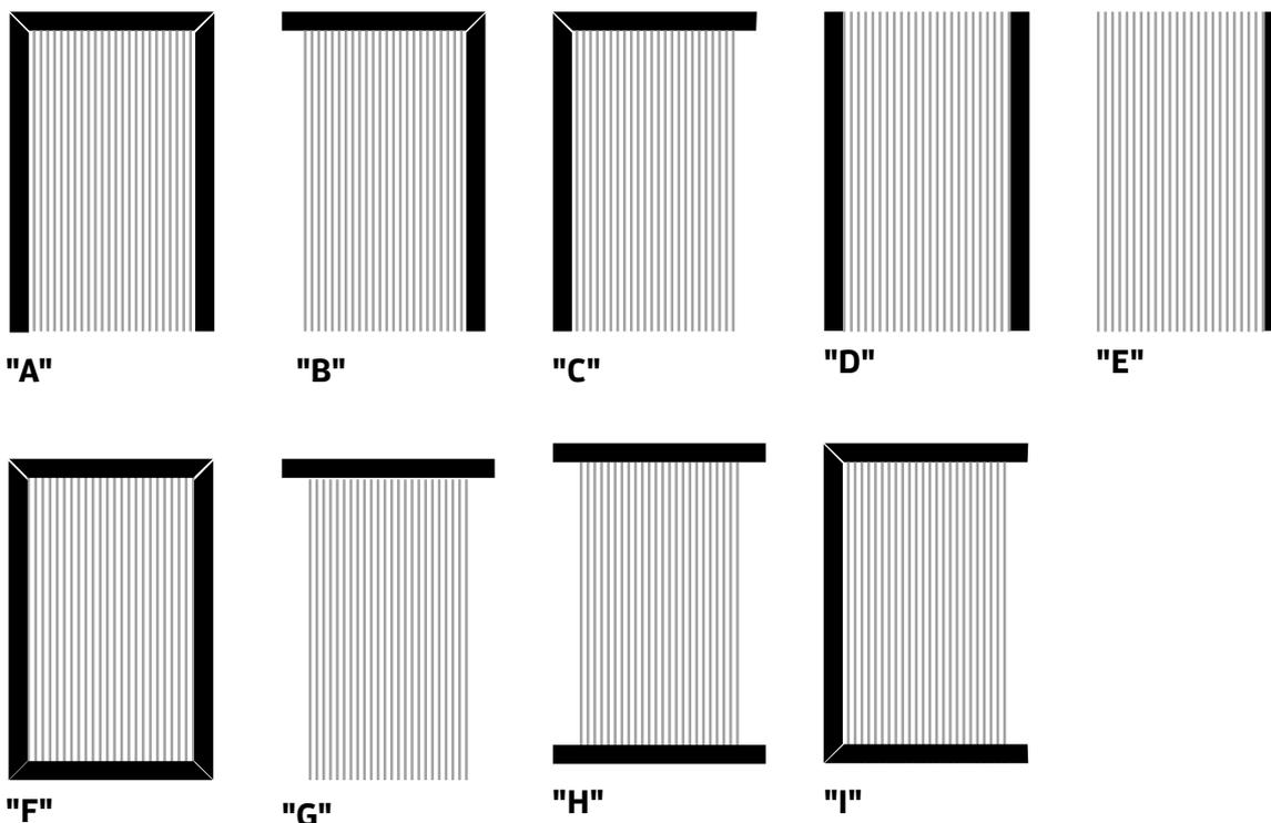
Le dimensioni della **Plissè -Jolly - Flexa - Libera - Star 50 - 0.18 - 0.22** a fissaggio frontale devono essere trasmesse in mm indicando base x altezza con le seguenti indicazioni.
